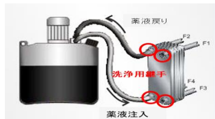
(洗浄ポンプの接続例)
